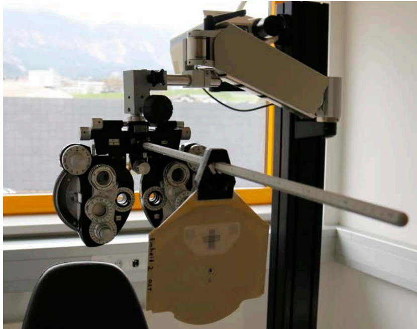
Abbildung 8 Autor: Christoph Krämer, Phoropter mit Nahprüfstange
