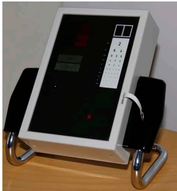
Abbildung 7 Autor: Christoph Krämer, Nahprüfgerät der Firma Rodenstock
